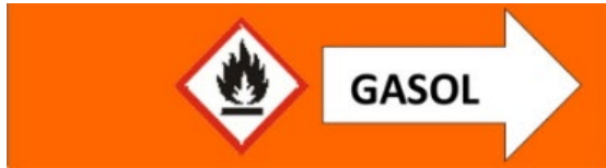
Figur 8 Exempel på märkning av rörledning för gasol.
