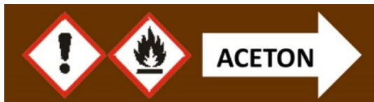
Figur 7 Exempel på märkning av rörledning för aceton
